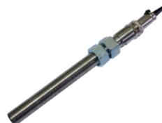
Os sensores magnéticos (pick-up magnéticos), são elementos projetados com a finalidade de gerar uma tensão pulsante (geradores de impulso), quando um objeto magnético, como por exemplo um pedaço de ferro em movimento, passar em frente ao pólo do sensor. Basicamente consistem de um ímã permanente e uma bobina, alojados dentro de um invólucro (carcaça) de material não magnético como o plástico, o aço inox, etc. conforme mostra o desenho esquemático da fig.1.
